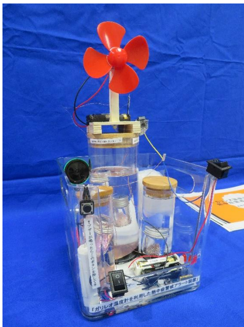
「ガリレオ温度計を利用した 熱中症警戒アラート装置」
