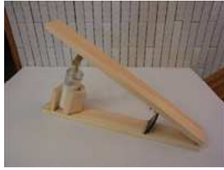
ダイレイタンスーを応用した 「急発進防止装置」
