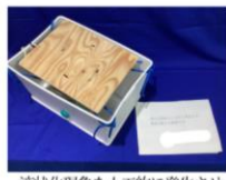
液化化現象を人工的に発生させ模型の動きを観察する
